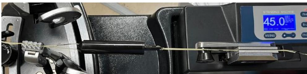
3、テンションキャリブレーターを設置し、「PULL」キーを押し引っ張ってください。
