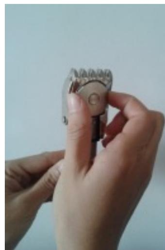
ガットを掴む強さを締めるには、ダイヤルを時計回りに、緩めるには半時計回りに回してください。
