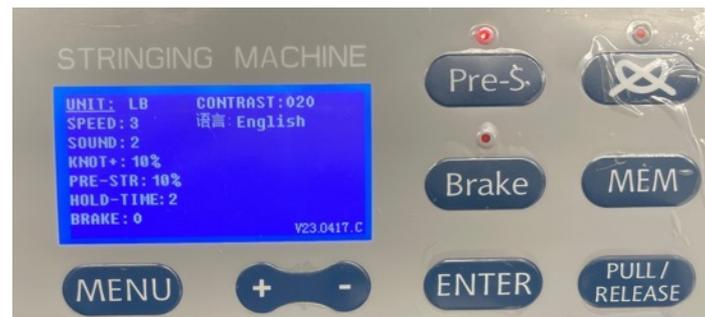
**MENU**ボタンを1回押すと、上画像のようにテンションユニット (lbsまたはkg表記)、スピード、音量、またはノットテンション、プレストレッチ、持続時間、などの設定が確認できます。
